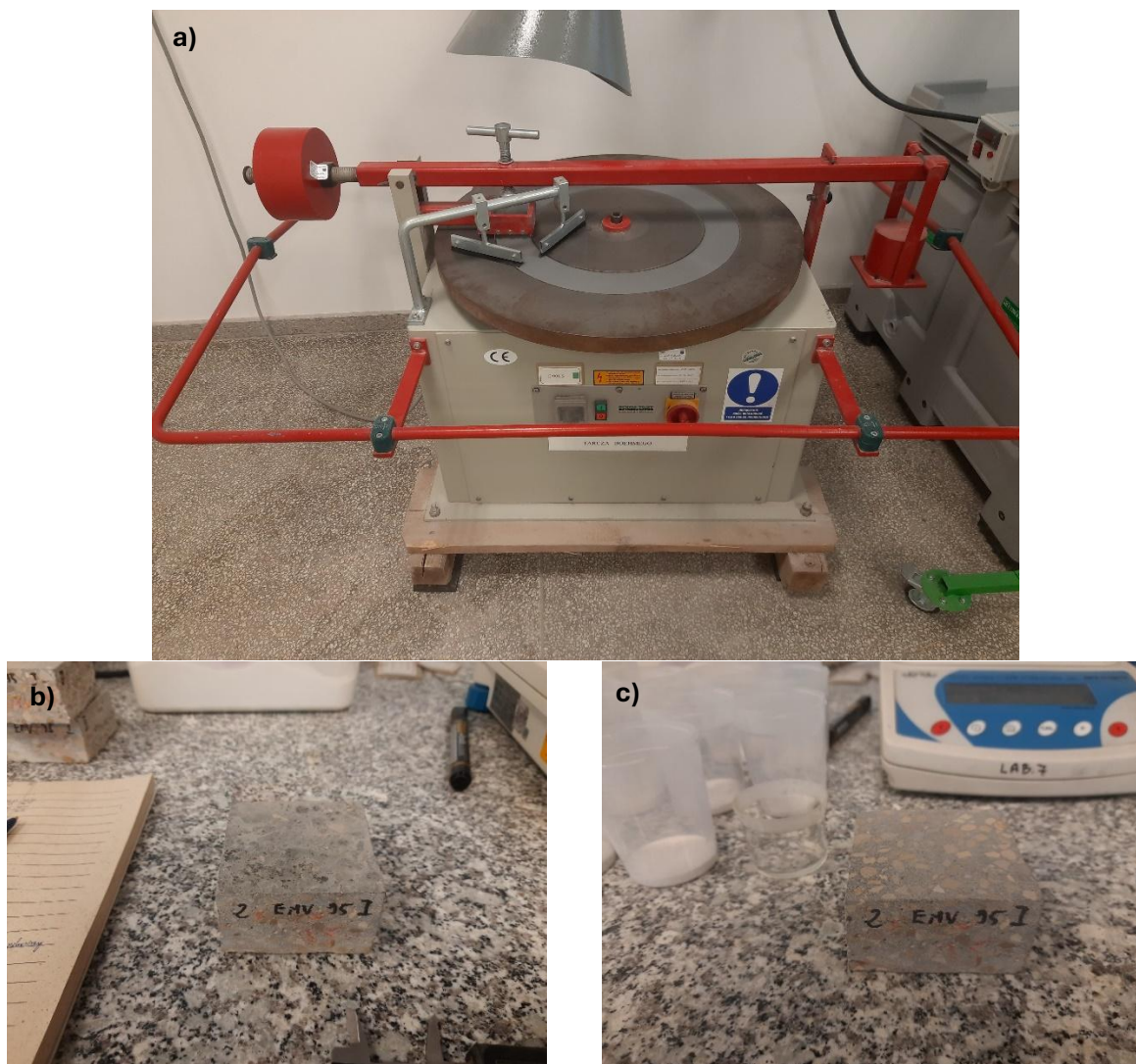
Rysunek 48. Badanie odporności na ścieranie: a) tarcza Böhme b) próbka przed badaniem c) próbka po badaniu
