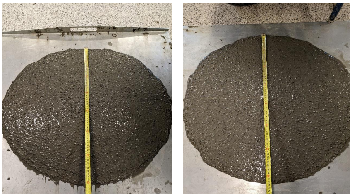
Rysunek 42. Świeża mieszanka bez segregacji ziaren i z równomiernym rozplywem
