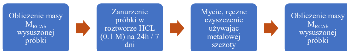
Rysunek 36. Proces obróbki kruszywa za pomocą kwasu
