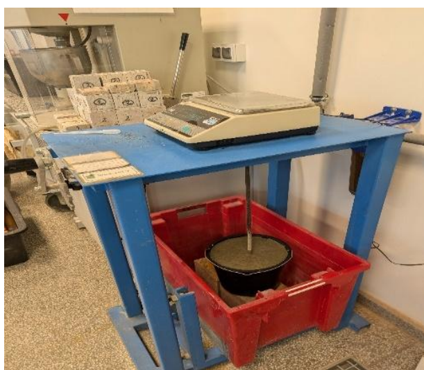
Rysunek 43. Czas wiązania betonu: a) schemat b) stanowisko badawcze
