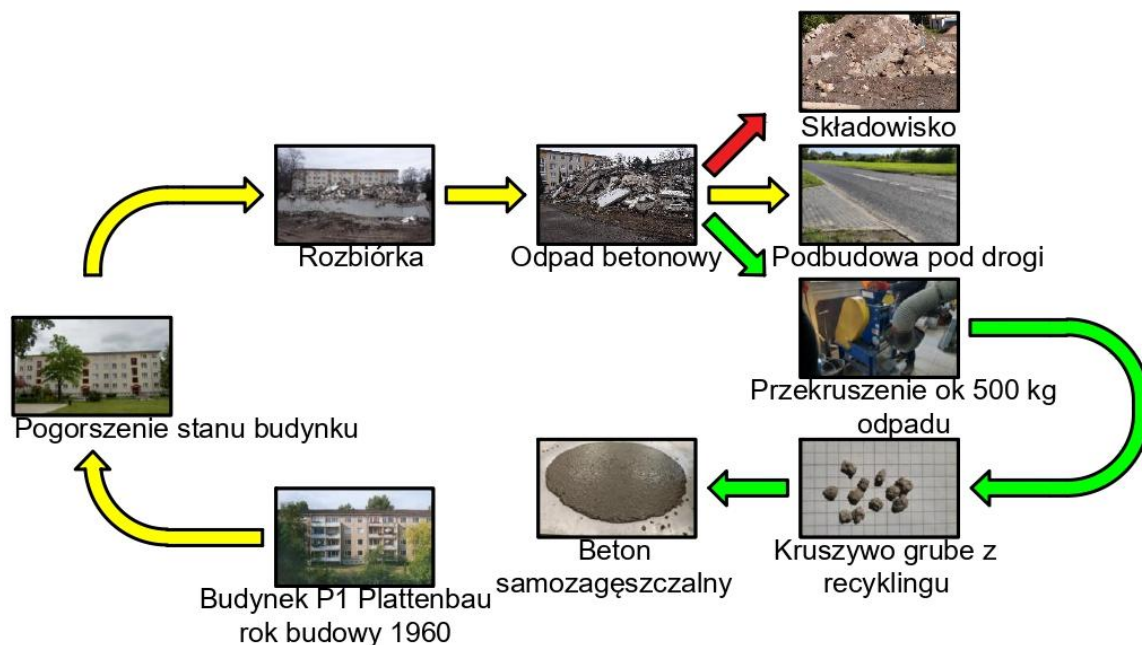
Rysunek 32. Proces pozyskiwania kruszywa w pracy w porównaniu do prawdopodobnej przyszłości odpadu na podstawie wywiadu środowiskowego z firmą wykonawczą przeprowadzającą rozbiórkę: kolor czerwony – podejście nieoptymalne, kolor żółty – podejście optymalne pod kątem utylizacji, ale niewykorzystujące potencjału odpadu, kolor zielony- zakres pracy doktorskiej
