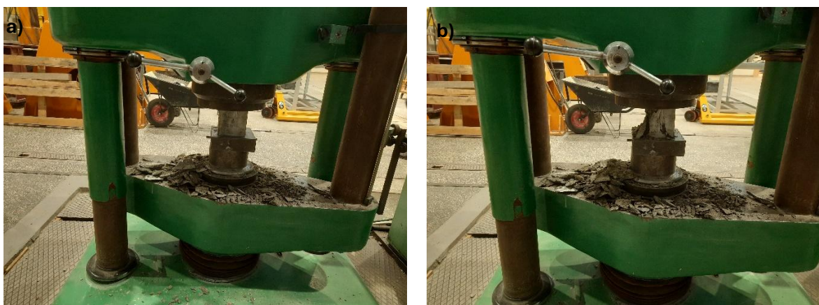
Rysunek 47. Badanie wytrzymałości na ściskanie: a) próbka przed badaniem b) próbka po badaniu
