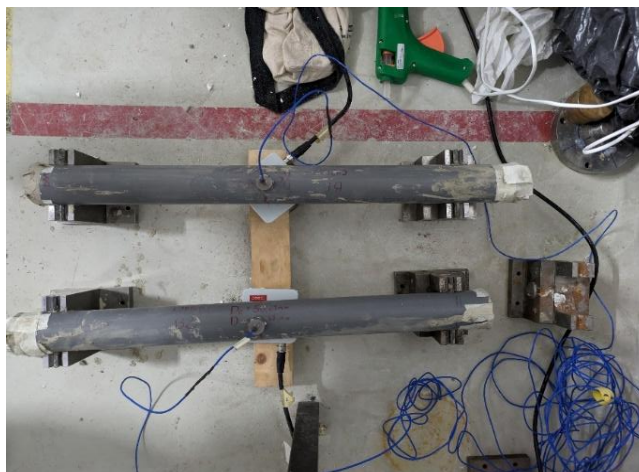
Rysunek 45. Badanie modułu sprężystości metodą EMM-ARM według [309]: a) schemat b) stanowisko badawcze
