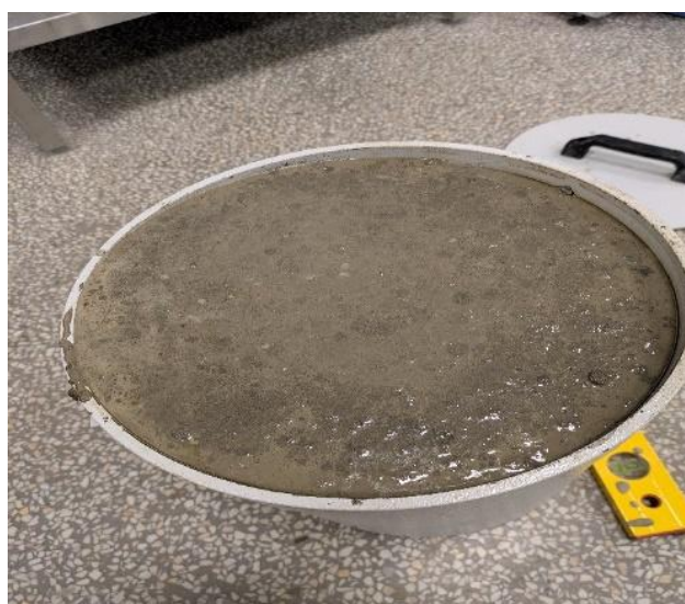
Rysunek 44. Odsączanie wody z mieszanki: a) schemat b) stanowisko badawcze
