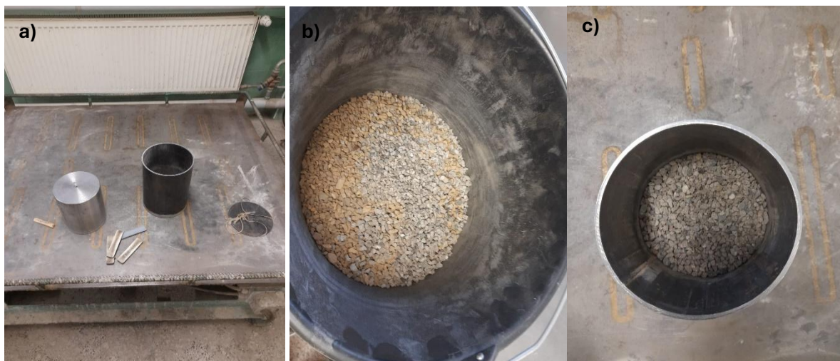
Rysunek 40. Badanie gęstości upakowania: a) cylinder z obciążnikiem b) stan przed badaniem dla próbki z 60 % NCA i 40 % RCA c) stan po badaniu dla próbki 100 % RCA
