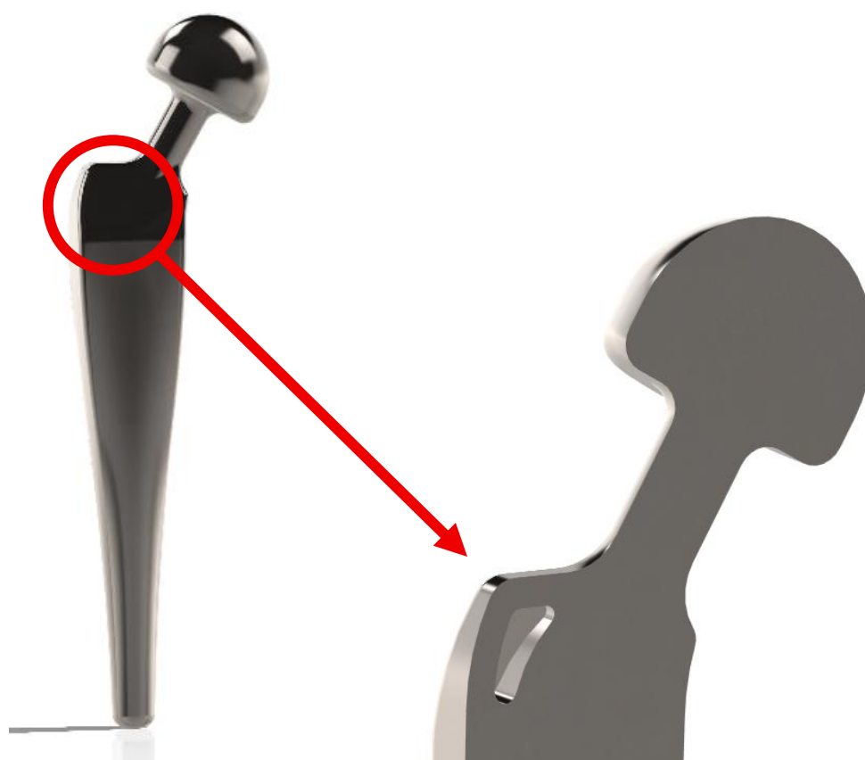
Rysunek 9.12. Przykład nietechnologicznego elementu w implancie w postaci zamkniętego otworu (prawy rysunek pokazuje przekrój)
