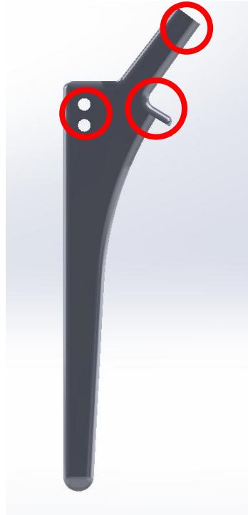
Rysunek 7.13. Miejsca zagęszczenia siatki elementów skończonych
