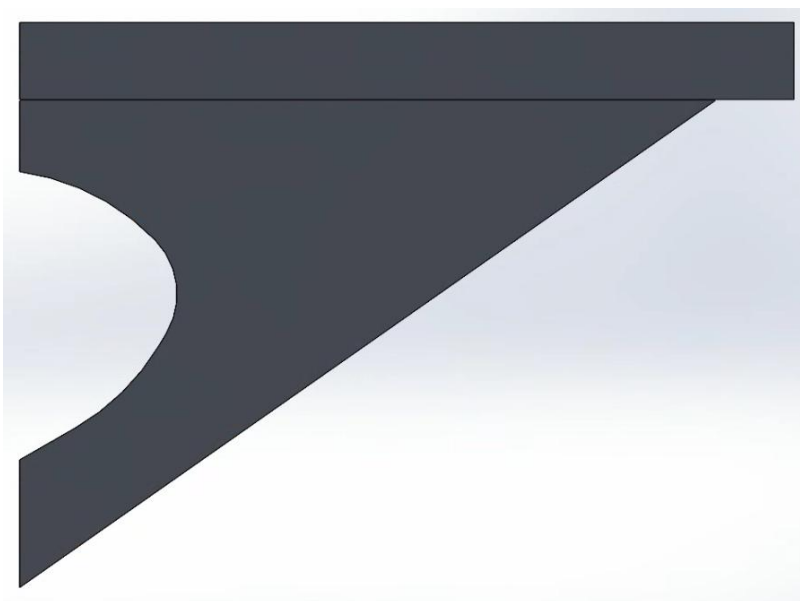
Rysunek 8.6. Osobnik A – ze swoim parametrem w postaci wycięcia w miejscu niskich naprężeń
